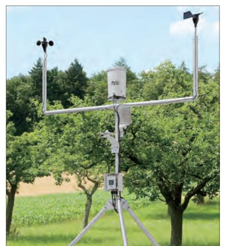
デルタオームではHD35シリーズの関連製品として、4G(LTE)モジュール内蔵の気象ステーション用データロガーHD33MT.4を準備しています。
