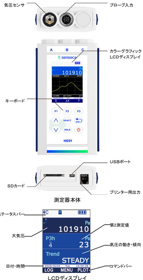
SDカードに直接CSVフォーマットでデータを保存する**データロギング機能**により、長期のロギングが可能です(例えば、4GBのSDカードでは、最小ロギングインターバル1秒で多くの物理量をロギングした場合でも、数ヶ月間ロギングが持続します)。保存インターバルはユーザー設定が可能です。手動または設定によるロギングスタート/ストップが可能です。記録された各データは日付および時間とともに保存されます。また、メモリーカード上でPDFフォーマットによる測定レポートの作成もできます。マニュアル(キーを押すだけで現在の測定値が取得可能)またはオート(1秒当り1回の測定値が取得可能)**RECORD機能**により、測定された値のMIN値、平均値、MAX値が得られます。
