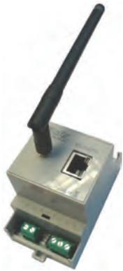
親機は、測定サイト内に設置されたネットワークデータロガーとPC/PLCのインターフェースとして働きます。リモートデータロガーが取得したデータを無線で受信し、次の何れかの方法でPC/PLCと通信します:
