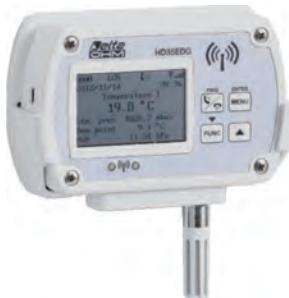
温度・湿度・大気圧用無線データロガー。グラフィックタイプLCDを搭載(オプションGタイプのみ)。データロガーは、内部メモリに測定値を保存し(22,000データ)、記録したデータを自動的に一定のインターバル、またはオン・デマンドで親機に送信します。
