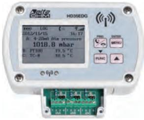
三つの入力端子を備えた無線データロガー。DC4～20mA、DC0～1Vおよび0～50mVのトランスミッタ、Pt100/Pt1000センサ、K、J、T、N、E熱電対、無電圧接点出力(1センサのみ)、ポテンショメータの接続ができます。グラフィックタイプLCDを搭載(オプションGタイプのみ)。データロガーは、内部メモリに測定値を保存し(36,000～68,000データ、接続されるセンサの数とタイプによる)、記録したデータを自動的に一定のインターバル、またはオン・デマンドで親機に送信します。内蔵ブザーによる可聴信号アラーム。ソフトウェアHD35AP-S(ウェブサイトよりダウンロード可能)または前面キーボード(ディスプレイ付機種のみ)による設定。内蔵電池による電源供給。着脱式壁掛けサポートあるいはオプションのフランジによる固定設置。
