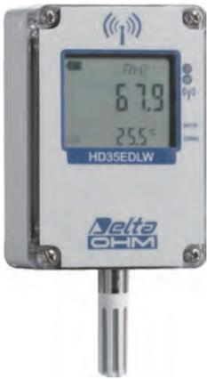
温湿度無線データロガー。IP67防水ハウジング仕様。カスタムタイプLCDを搭載(オプションLタイプのみ)。データロガーは、内部メモリに測定値を保存し(24,000データ)、記録したデータを自動的に一定のインターバル、またはオン・デマンドで親機に送信します。
