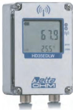
日射・太陽パネル温度用無線データロガー。IP67防水ハウジング仕様。カスタムタイプLCDを搭載（オプションLタイプのみ）。データロガーは、内部メモリに測定値を保存し（36,000データ）、記録したデータを自動的に一定のインターバル、またはオン・デマンドで親機に送信します。
