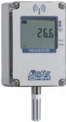
温度無線データロガー。IP67防水ハウジング仕様。カスタムタイプLCDを搭載(オプションLタイプのみ)。データロガーは、内部メモリに測定値を保存し(68,000データ)、記録したデータを自動的に一定のインターバル、またはオン・デマンドで親機に送信します。
