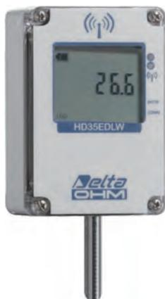
温度無線データロガー(トンネル式フリーザー用)。IP67防水ハウジング仕様。カスタムタイプLCDを搭載(オプションLタイプのみ)。データロガーは、内部メモリに測定値を保存し(68,000データ)、記録したデータを自動的に一定のインターバル、またはオン・デマンドで親機に送信します。
