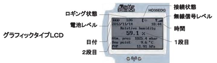
LCD表示付のデータロガーの機種は測定値を異なる測定単位で表示することができます。
